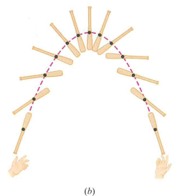
그림 9-1 (a) 포물선 경로를 따라 움직이는 공. (b) 야구방망이의 질량중심(검은 점)은 간단한 포물선 경로로 움직이지만 다른 점들은 복잡한 경로를 따른다.
